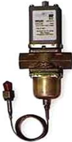
شكل رقم (16) صمام تنظيم تدفق الماء للمكثف المائي يعمل بتأثير الضغط
